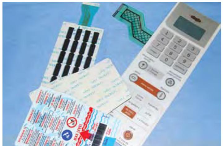
这是在透明PET基材上单面涂有压敏胶粘合剂的胶带。具有优良的粘合力和持粘力，加工性好。
