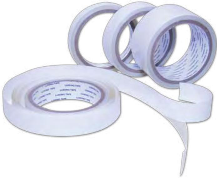
这是在PET基材上一面涂有有机硅压敏胶粘合剂，而另一面涂有丙烯酸酯压敏胶的双面胶带。具有优良的粘合力 and 持粘力，加工性好。
